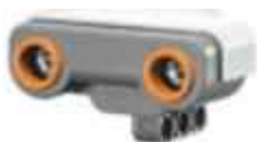
9846 – NXT Ультразвуковой датчик
