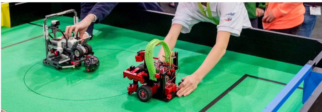
Рис. 1. Две команды с одним роботом лиги легкого веса будут соревноваться с использованием ИК-мяча на футбольных полях RCJ Soccer без внешней зоны аутов. Нет необходимости использовать камеру или сенсор для обнаружения линий. Фото: Андреас Ландер
